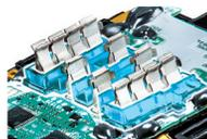
Estructura de prevención de cortocircuitos en los terminales
